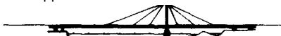
Мост в Кельне через Рейн с балками коробчатого сечения на наклонных канатах пролетом 297 м (1959)
