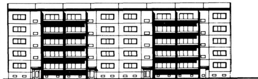
Нейбранденбург, фасад жилого дома, возведенный по методу крупнопанельного строительства, смонтирован в 1975 г.
